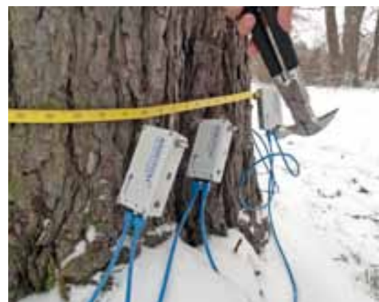
Akustický tomograf – průběh vlastního měření (přístroj ARBOTOM 3D).
