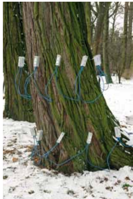
Rozmístění senzorů akustického tomografu na kmenu hodnoceného stromu (přístroj ARBOTOM 3D).
