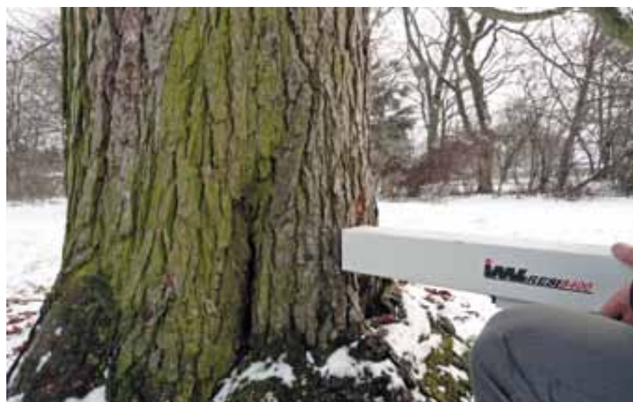
Hodnocení vlastností dřeva stromu pomocí penetrometru (přístroj Resistograph).
